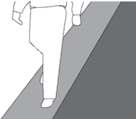
Bei nicht begehbaren Dachabdichtungen müssen in jedem Fall Laufwege vorgesehen werden, auf denen die technischen Bauelemente und die Anlagen auf dem Dach erreicht werden können. Diese Laufwege müssen mit Bodenbelägen oder mit zusätzlichen Schichten Dichtungsbahnen angelegt werden und leicht erkennbar und zugänglich sein, damit die Dachabdichtung nicht beschädigt wird.
