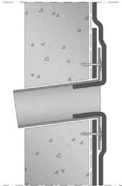
Die Überläufe werden in einer Höhe von ca. 10-15 cm über dem Verlegeuntergrund an den vertikalen Bauelementen der Dachumrandung angelegt. Die Dichtungsbahnen müssen über den Überlaufstutzen geführt und mit diesem verklebt werden. Die Vorgehensweise ist die gleiche wie bei den Abläufen auf der Dachfläche.
