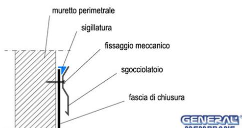
Fig. 21 – coronamento superiore di risvolto verticale: soluzione con profilo metallico a gocciolatoio
