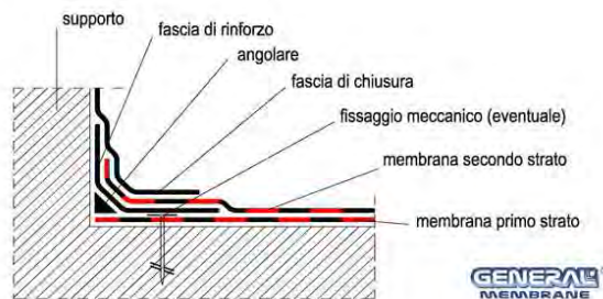
Fig. 19 - risvolto verticale doppio strato – Tipo 3
