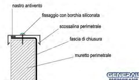
Fig. 21 - coronamento superiore di risvolto verticale: soluzione con lattonerie conformata alla testa del muretto
